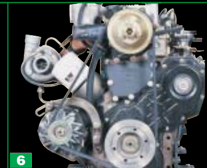
6 Pompa acqua per comando ventola in posizione sopraelevata. High Mount Fan Drive.
