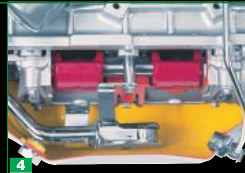
4 Contralberi di equilibratura. Counter balancing shaft.
