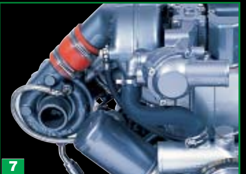
7 Turbocompressore in posizione laterale. Side Mounted Turbocharger.
